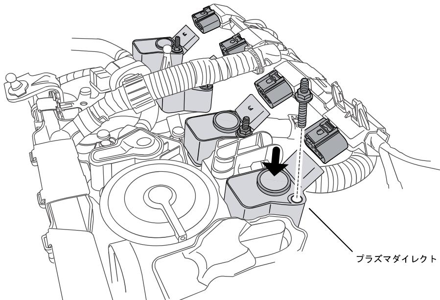
④ 手順 1 で取り外したエンジンカバー等を元通りに取り付けて下さい。
