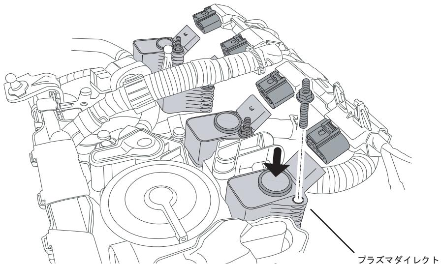
⑥ 手順 1 で取り外したエンジンカバー等を元通りに取り付けて下さい。
