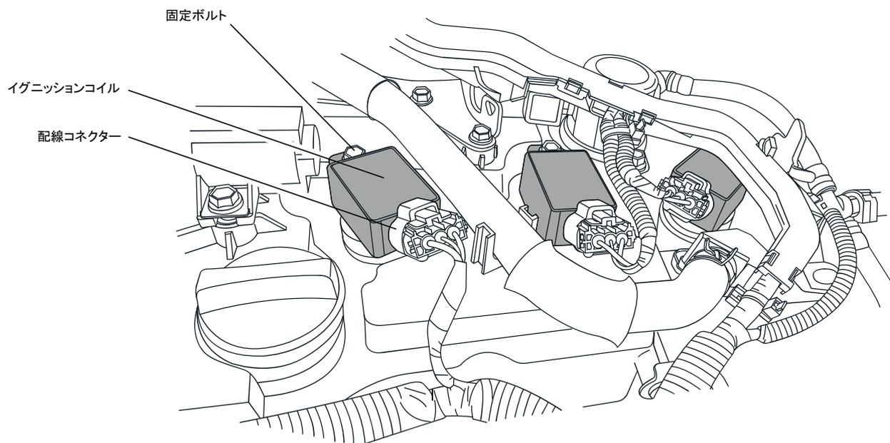
3 プラズマダイレクト、固定ボルト、配線コネクターを全て取り付けてください。
