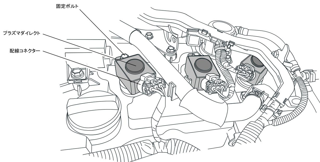
4 プラズマダイレクトは純正イグニッションコイルに比べ高さがありますので、付属の8mmスペーサーを使用して配線ケースをかさ上げします。
