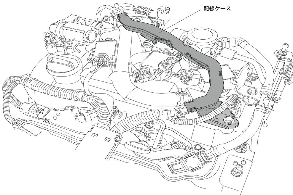
2 イグニッションコイルから固定ボルト、配線コネクターを外し、イグニッションコイル全てをエンジンから取り外してください。
