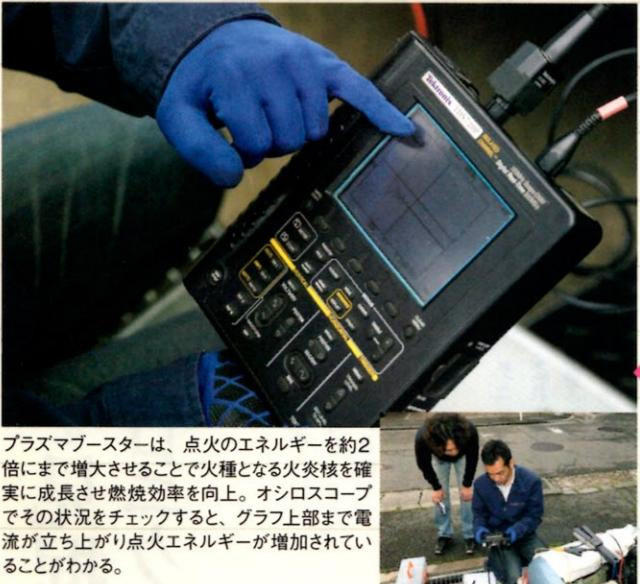
プラズマブースターは、点火のエネルギーを数倍にまで増大させることで火種となる実に成長させ燃焼効率を向上。オーバーでその状況をチェックすると、グラフから流れが立ち上がり点火エネルギーが高まっていることがわかる。
