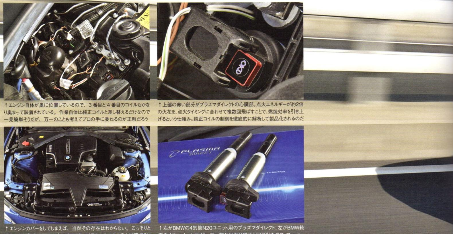
↑エンジン自体が奥に位置しているので、3番目と4番目のコイルもかなり奥まで装着されている。作業自体は純正コイルと差し替えるだけなので一見簡単そうだが、万一のことも考えてプロの手に委ねるのが正解だろ
