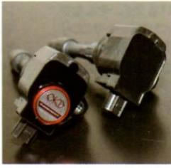
S660に搭載されるS07Aエンジンは3気筒なので、コイルも3本。装着作業は純正コイルを取り外し、そのままプラズマダイレクトを交換するだけのボルトオン装着だが、作業の確実性などから、オカダプロジェクトではDIYではなくショッピングでの交換を推奨している。
