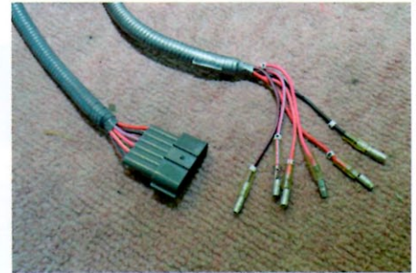
右が従来のプラズマダイレクト。左が新作の同商品である。各気筒ずつ1本ずつ計6本のハーネスをカブラーで束ねた
