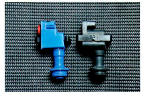
写真左は純正。右のプラズマダイレクトはトランジスタを内蔵しており、純正パワートランジスタが不要となった
