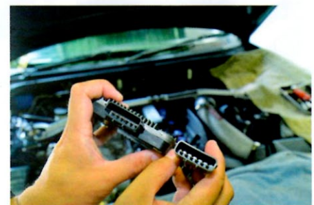
カブラーオンで装着できなかった理由は、パワートランジスタ側のカブラーを再現できなかったため。専用品を製作
