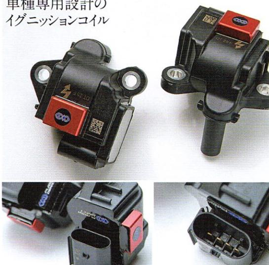
マルチスパークにより完全燃焼を促進。エンジン性能の向上を実現するほか、ノックングを抑制するなどでエンジンの負荷も低減。レッドのワンポイントがアイコンだ
