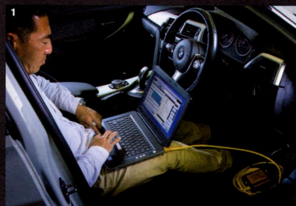
1. OBDIIポートから点火状態を診断する。走りながらリアルタイムで測定することもできるので、プロトタイプを交換しながらテストを繰り返す 2. コイル部分以外は純正と基本的には同形なので装着は差し替えるだけだが、一部の車種では作業が困難な場合もあるため、プロショップに委ねた方がいい
