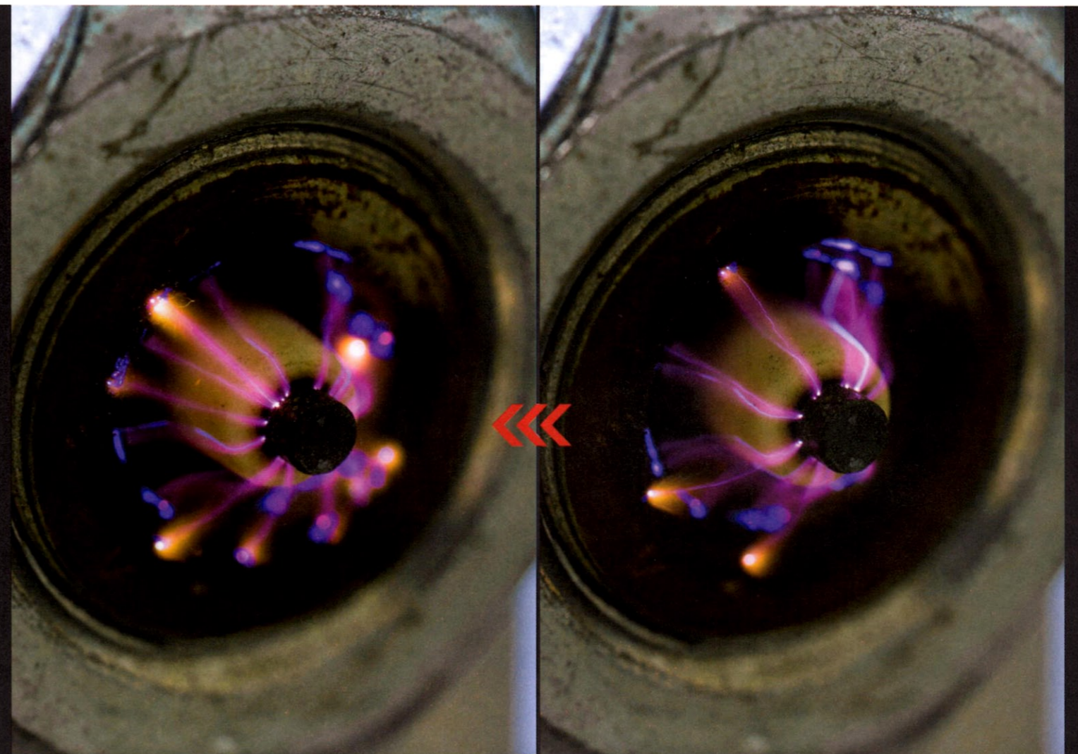
↑右が純正イグニッションコイル時のスパークプラグで、左がプラズマダイレクトに変更した状態。その差は一目瞭然。電極から飛ぶ火花の量が増え、一本一本が太くなっている
