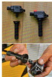
プラグブーツは純正を利用する。方法は、純正イグニッションコイルからはずして、プラズマダイレクトに取り付けるだけ
