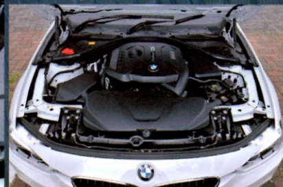
↑昨年新型へと切り替わった2.0直列4気筒エンジン、B48。横置きミニなどと共用の1気筒500ccのモジュラーエンジン。ノーマルでは184hp/270Nmを発揮する
