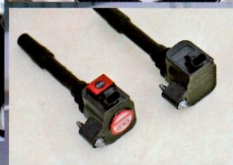
↑ノーマルのイグニッションコイル(右)とはほぼ同形状のプラズマダイレクト(左)。コイルや制御基板の一部を筐体の外に新設している
