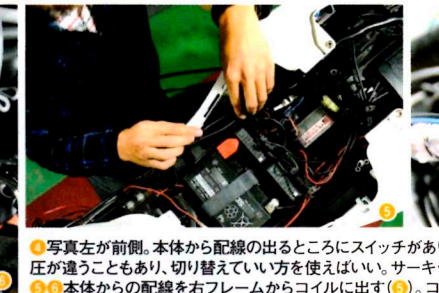
⑤本体からの配線を右フレームからコイルに出す。コイル側は2個ともプラス側配線を外しておく
