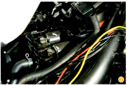
②プラズマVプラス本体を装着。CB400Fではシート下空間を活用して両面テープ(面ファスナーでもOK)でセットした
