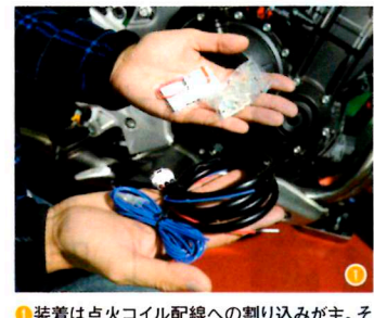
③装着は点火コイル配線への割り込みが主。そのためのコードや端子類も1~4コイル分がパッケージに同梱されているので心配なし
