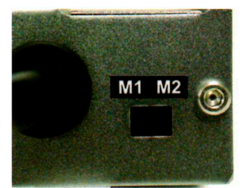
◎15Vのモード1と16Vのモード2の切り替えスイッチも用意。周囲と干渉して不意に切り替わらないよう奥まった位置となる
