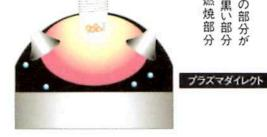
電流アップ(電圧アップではない)とマルチスパークによって、プラグを中心とした火種が大きくなり火炎伝播の効率が上がるの、不完全燃焼が少なくなるのが最大のメリットといえる
