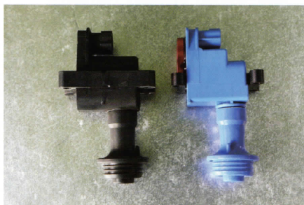
写真左は純正。プラズマダイレクト(右)は内部にトランジスタを内蔵しているため、純正のパワートランジスタが不要に
