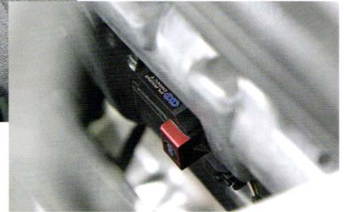
FA20は水平対向エンジンのためコイルの装着位置が非常に奥まった場所にあるが、エンジンを降ろさずに装着することは可能。プラグ交換のついでに施行すれば手間が省けるとのことだ。
