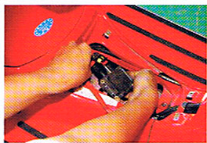
①ベスパのイグニッションコイルはステップボード内側にある。かなりキツかったが手と工具を入れて何とか外せた
