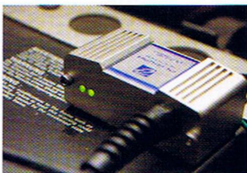
③プラズマブースター・タイプBでは点火確認のために本体にLEDを搭載。正常に取り付けられていれば、エンジンの点火に合わせてLEDが点滅するため動作確認が可能
