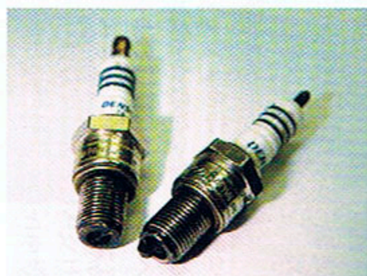
⑦ 点火に大きくかわるのが点火プラグ。少しずつ劣化が進むためパフォーマンスの低下が体感しづらい部分だが、定期的な交換することで適切な点火を維持したい
