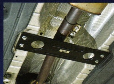
中央のメインプレートと中央リア側の2か所の補強が基本のステージ1(定価は2万6000円+税)。
