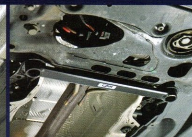
フロントサスの付け根を補強するフロントメンバープレース(定価は2万円+税)の追加がステージ2。
