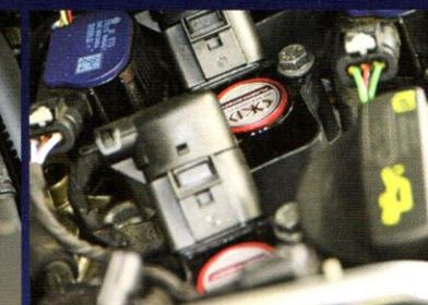
簡単にいうと、シリンダーの燃焼工程での点火回数を増やし、なおかつスパークの力を2倍以上にするパーツだ。
